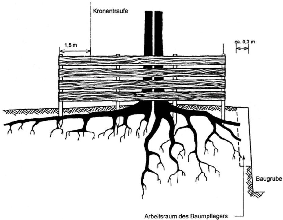
Wurzelvorhang bis zur Verfüllung der Baugrube feucht halten.
